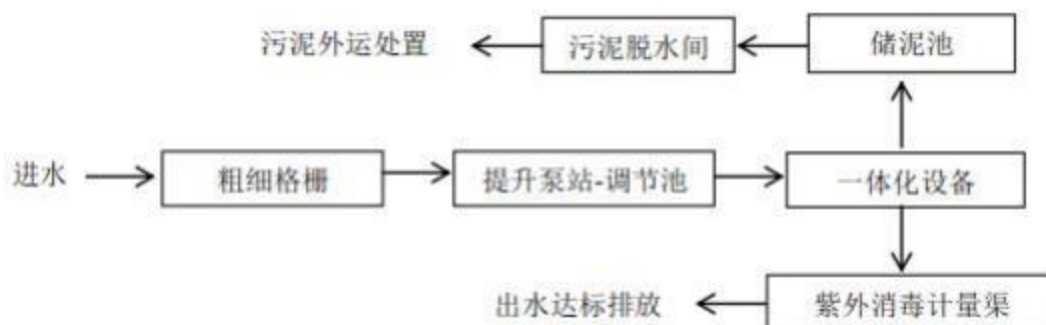
图 3-4 污水处理厂运营工艺流程图
